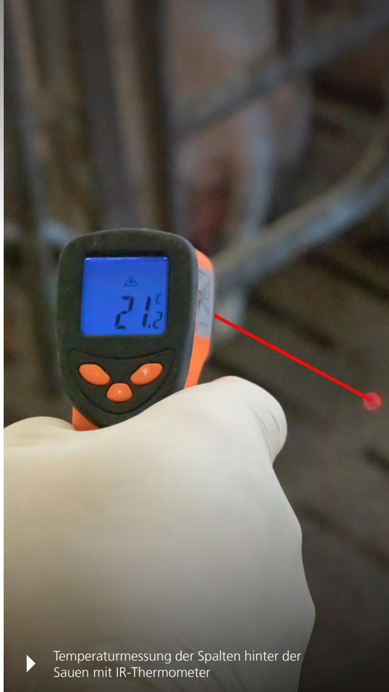
► Temperaturmessung der Spalten hinter der Sauen mit IR-Thermometer
